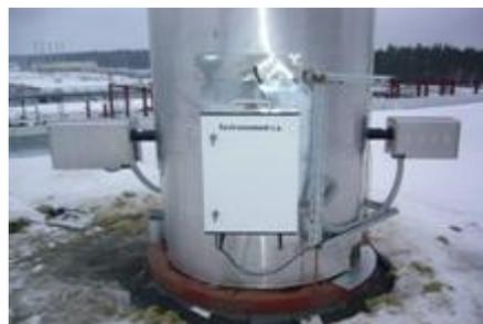
Рис. 1. Внешний вид средств контроля газодымовых выбросов («Environnement S.A.», Франция)
